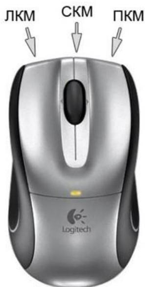
Рис. 3.3. Функции манипулятора
